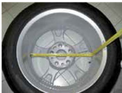
Figur F3.3.1 Et eksempel på en manuell måling av utvendig diameter ( da_2 ) på et hjul i programtypen ALS 1 / ALS 2.
